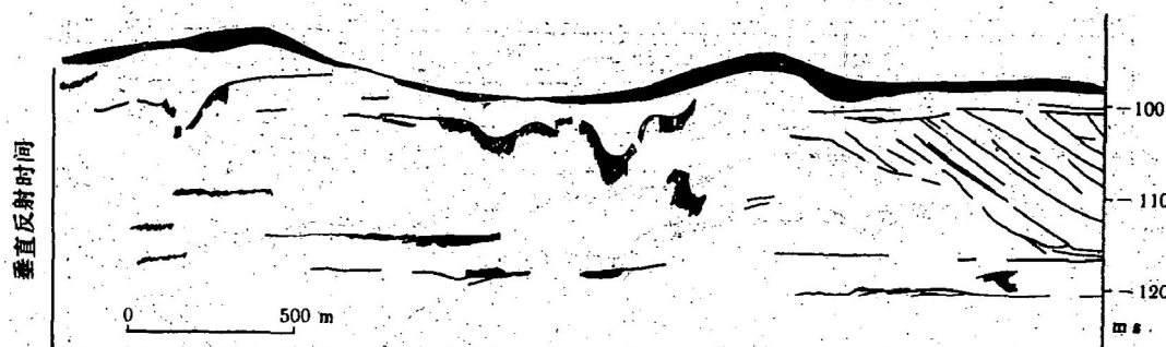
图7 海底砂丘 (3.5 kHz 浅层剖面)
